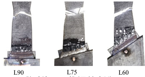
B) 破壊モードB(母材破断)
