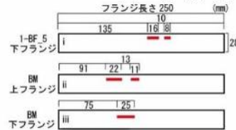
図 3 溶接欠陥箇所
