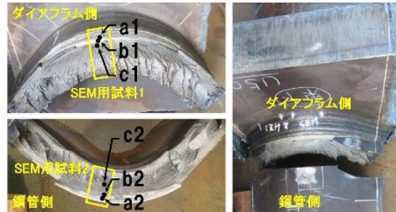
図 7 T50 破面 SEM 採取位置
