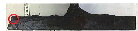
f) S_ML_W (ミニスカラップ/表層欠陥/ウェブ溶接)
